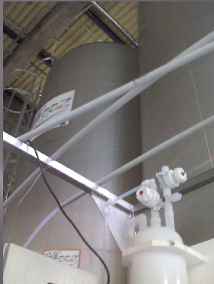
емкости для хранения сцинтиллятора 33 м<sup>3</sup> каждая.
