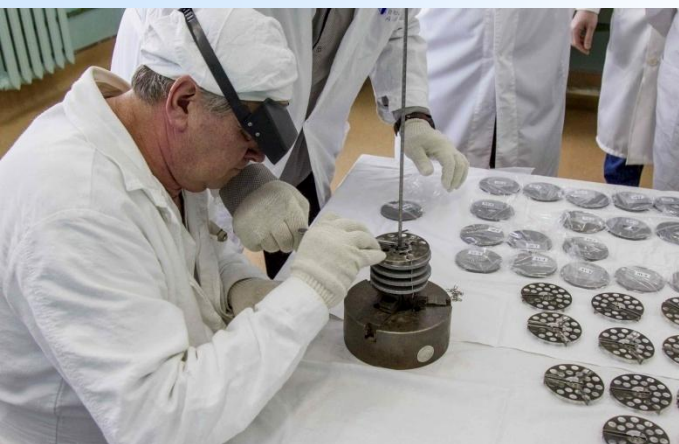
Сборка стартовой мишени из хромовых дисков для размещения в ОУ
