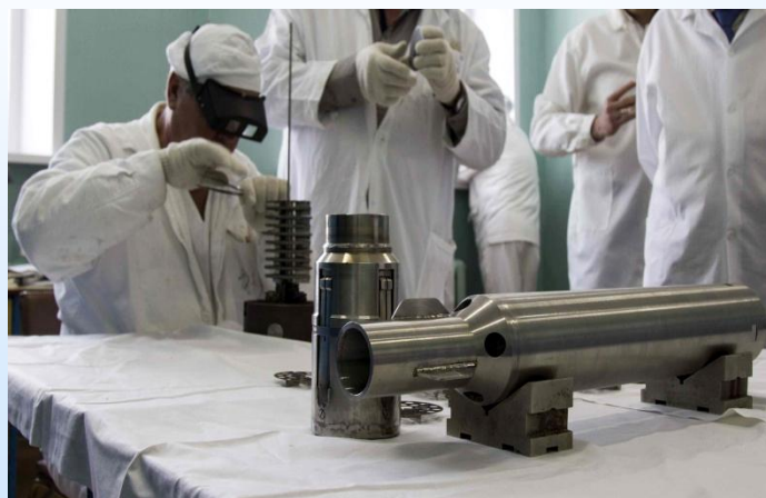
Сборка стартовой мишени из хромовых дисков для размещения в ОУ
