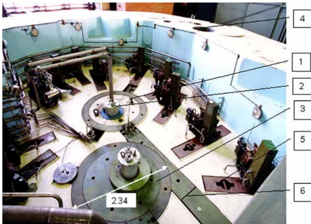
Рис.11. Фотография центральной верхней части комплекса источников нейтронов: 1 — бокс импульсного источника нейтронов, 2 — верхняя часть мишенного модуля, 3 — второй бокс, 4 — вертикальные проходки для установки дополнительного экспериментального оборудования, 5 — нейтроноводы - 6 — стальная защита протонных пучков
