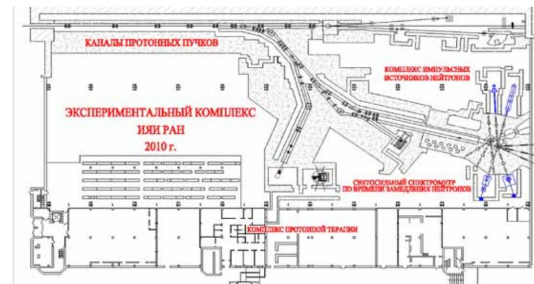
Рис. 9. Расположение объектов экспериментального комплекса (систем проводки пучков, биологической защиты, нейтронных мишеней и нейтронографических установок на нейтроноводах [12, 13]).
