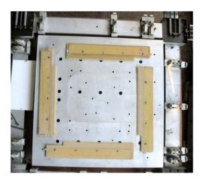
Рис.11. Подготовка к склеиванию рамы пропорциональной камеры. Рама склеивается из четырех сторон с приклеиванием печатных электродов, на которые распаиваются разъемы или непосредственно дискретные элементы распределенной линии задержки. Стороны рамы изготовлены методом вакуумного литья в форме, изготовленной с точностью 20 мкм. Состав материала рамы: 50% эпоксидный компаунд К115 и 50% кварцевый песок
