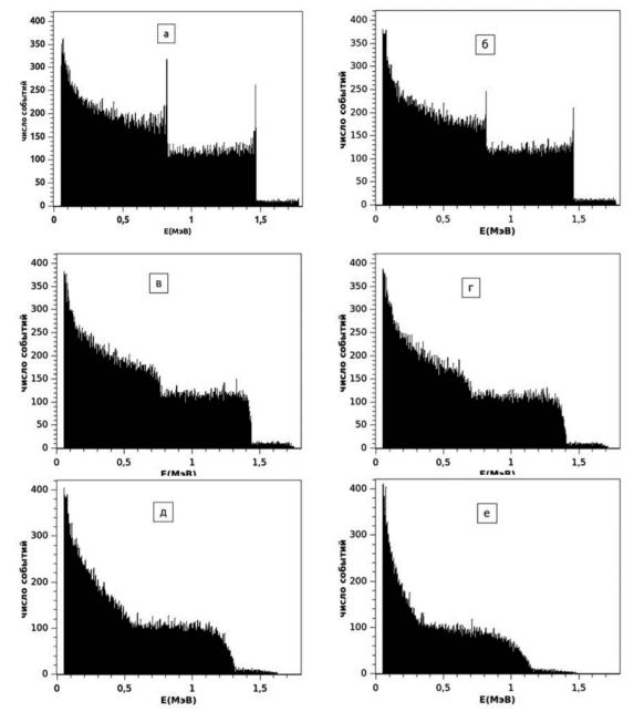
$Puc.\ 1.$  Ожидаемый спектр заряженных частиц с энергиями 1470 кэВ  $^4$ Не и 830 кэВ  $^7$ Li, вылетающих из слоя бора толщиной 2,5 мкм с различной толщиной алюминиевого слоя на его поверхности:
