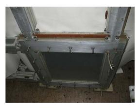
Рис 14. Двухкоординатная пропорциональная камера с чувствительной областью  $400 \times 400 \text{ мm}^2$  в собранном виде
