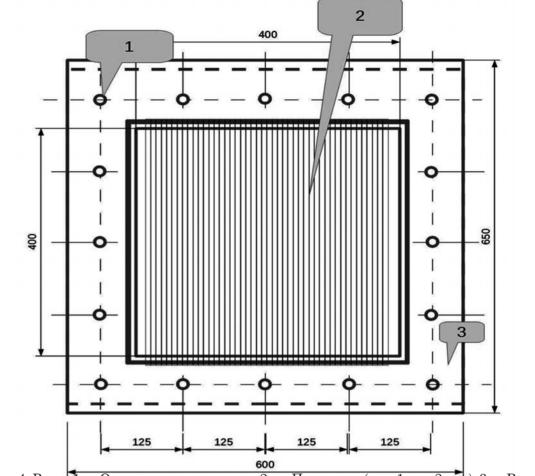
Рис. 4. Рама. 1 — Отверстие для шпильки. 2 — Проволоки (шаг 1 или 2 мм.). 3 — Рама
