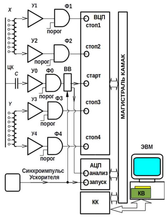
*Puc.* 7. Структурная схема системы сбора данных с модулями КАМАК. КК — крейт контроллер, КВ — плата РСІ контроллера ветви
