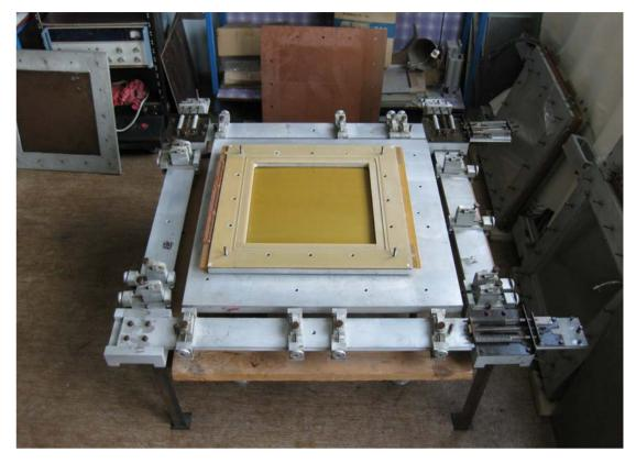
Puc~12. Стол для склеивания рам. Устройство для натяжения пленки и изготовления рам с пленочными электродами или рам с электродами из фольги. Размер стола  $800{\times}800~{\rm mm}^2$
