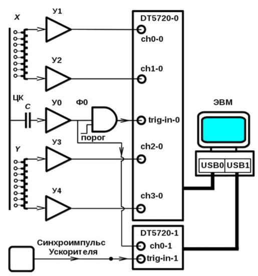
Рис. 8. Структурная схема системы сбора данных с модулями CAEN DT5720
