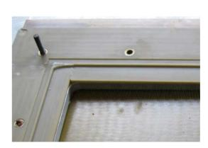
Puc 13. Угол рамы пропорциональной камеры с проволокой
