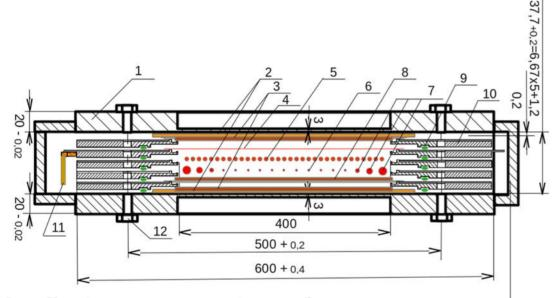
Puc.3. Устройство пропорциональной камеры. Элементы внутри окна камеры показаны уменьшенными по горизонтали.
