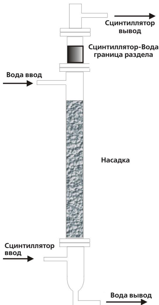
Рис.6. Принципиальная схема барботирования сцинтилятора
