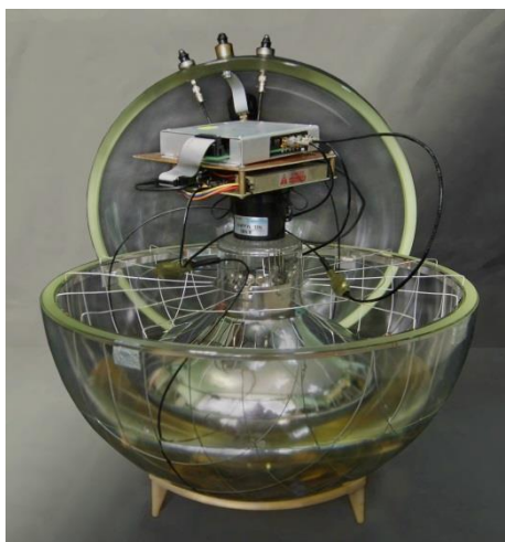
Рис. 2.2.4. Оптический модуль на основе ФЭУ R-7081HQE (версия 2010 года).
