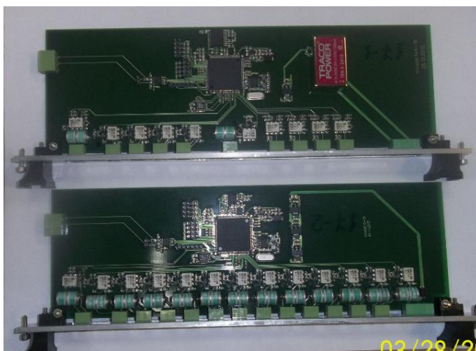
Рис. 4.1.4. Внешний вид плат триггерной логики: плата триггера гирлянды (сверху) и кластера (снизу).
