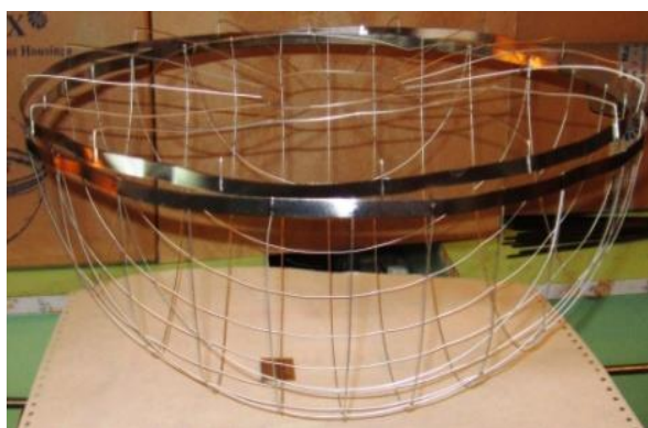
Рис. 3.1.2. Фотография магнитного экрана - сетки из пермаллоя.
