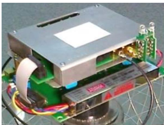
Рис. 3.1.7. Блок электроники ОМ, установленный на цоколе ФЭУ.
