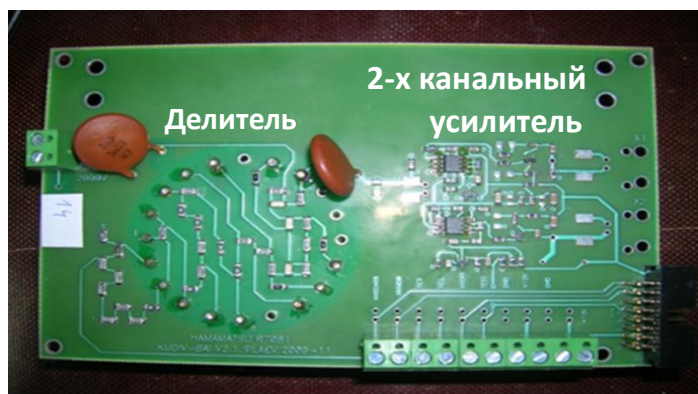
Рис. 3.1.9. Плата делителя и усилителя сигналов ФЭУ.
