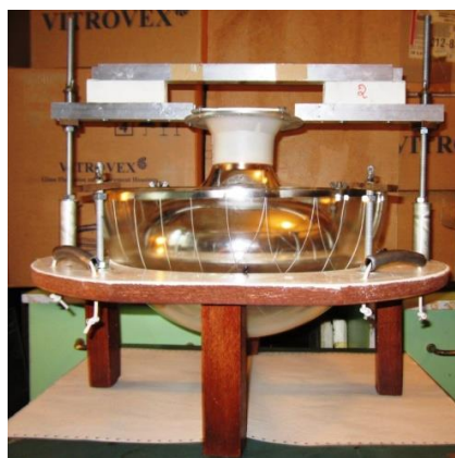
Рис. 3.3.2. Монтажный станец для монтажа ФЭУ и магнитного экрана.
