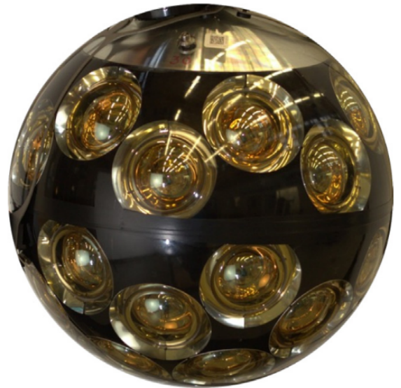
Рис. 1.32: Вид оптического модуля КМ3NeT. Содержит 31 ФЭУ диаметром 3". Взято из [10].
