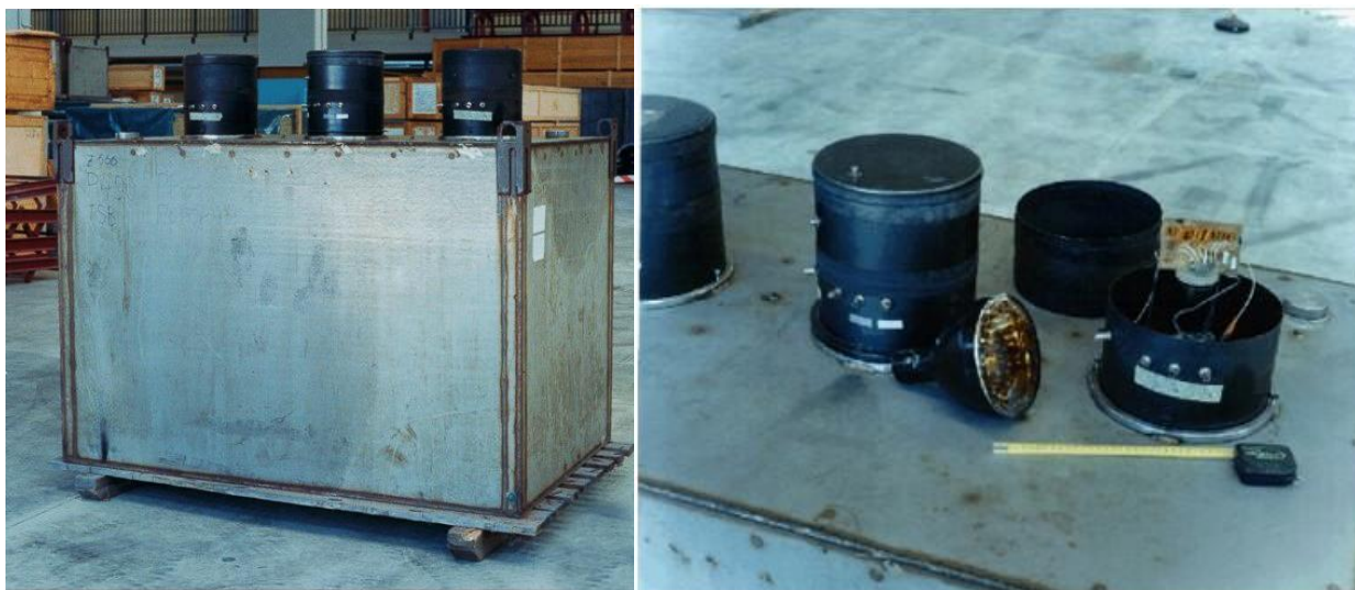
Рисунок 1.3 – Общий вид одного счетчика LVD (слева) и верхняя грань счетчика, с вмонтированными ФЭУ (справа).
