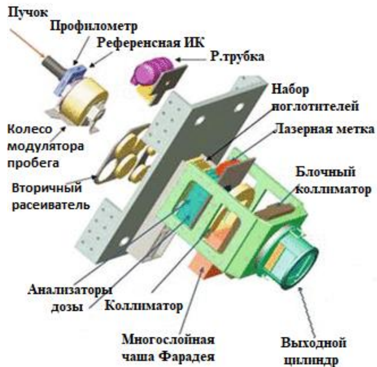
Рис. 1.11. Система формирования пучка производства Hitachi
