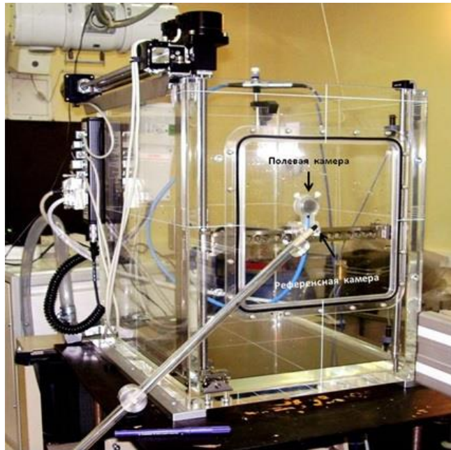
Рис. 4.3. Водный фантом МР3-Р Т41029. На фото видно расположение референсной ионизационной камеры на штанге с держателем, резервуар и полевую ионизационную камеру в креплении позиционера фантома.
