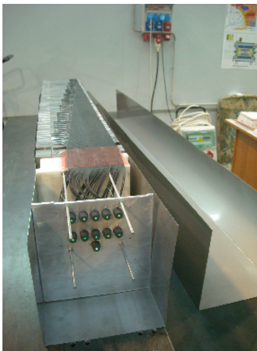
Рисунок 1.17 — Фотография собранного модуля адронного калориметра эксперимента CBM без верхней крышки.
