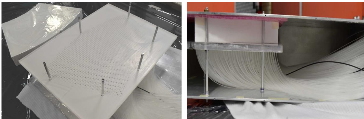
Рисунок 2.51. Фотографии прототипа сцинтилляционной подсистемы детектора FIT с использованием прозрачных волокон. Источник: [132].
