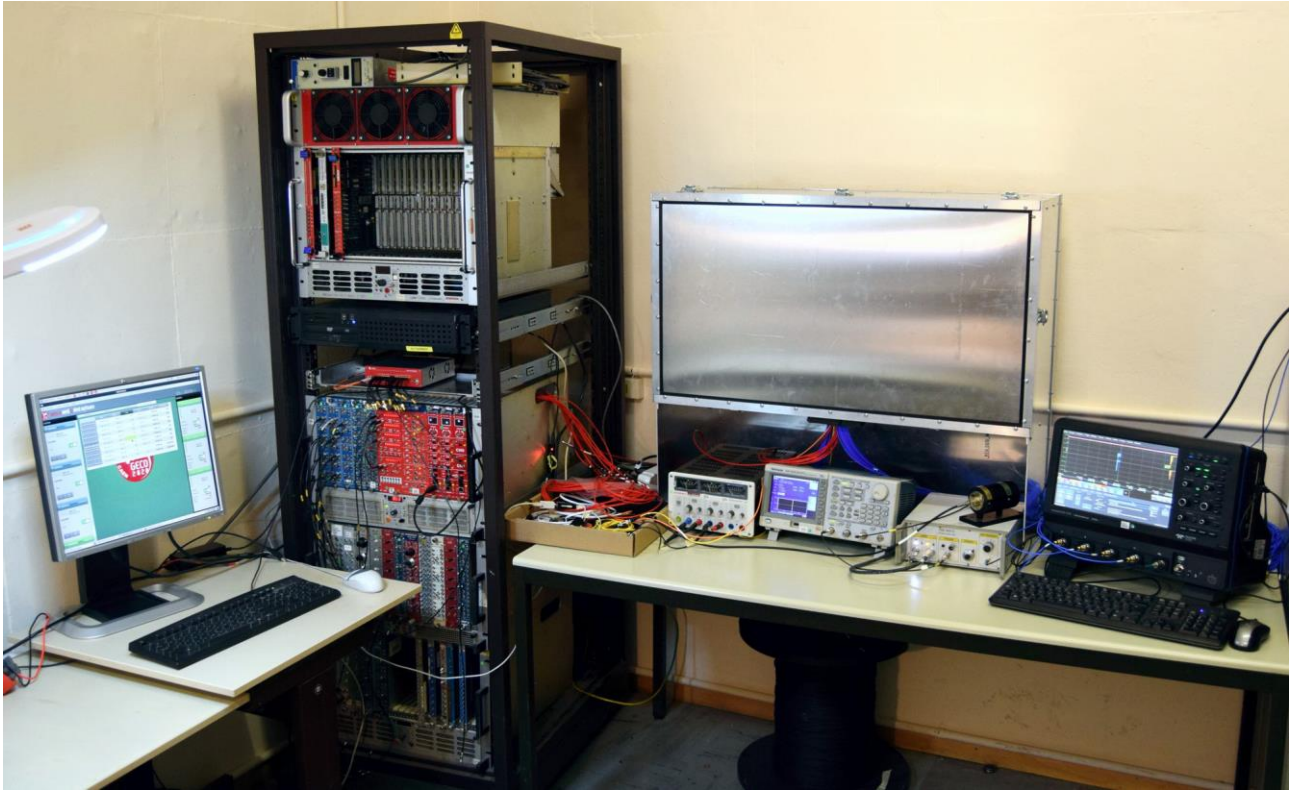
Рисунок 3.16. Экспериментальный стенд для входного тестирования и характеристики МКП-ФЭУ. Фото автора.
