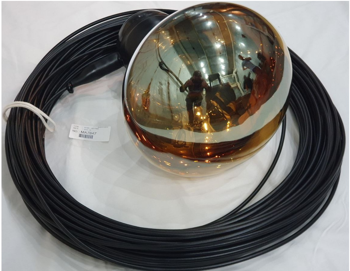
Рисунок 4.2 — Изображение фотоумножителя R7081-100 WA-SA70.
